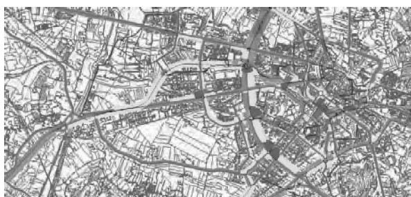
Rapporto flussi/capacità nell'ora di punta del giorno feriale tipo a scuole aperte ad Arezzo, PUMS Sintagma (CUBE)
