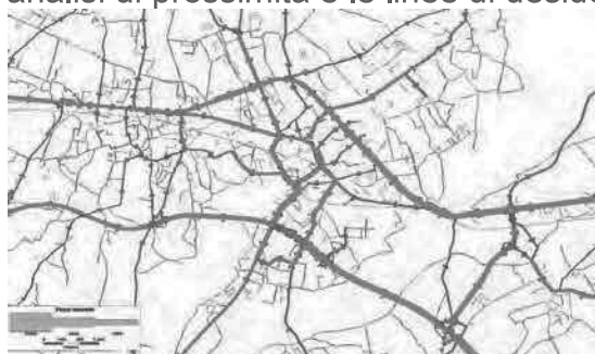
Flussi multimodali a Pordenone, modello di simulazione Sintagma (TRANSCAD)
