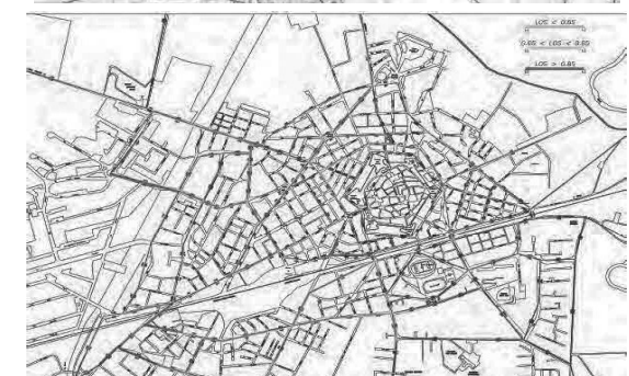
Estratto zonizzazione e flussogramma con rapporto flussi/capacità del comune di Grosseto, PUM e PUMS Sintagma (EMME)
